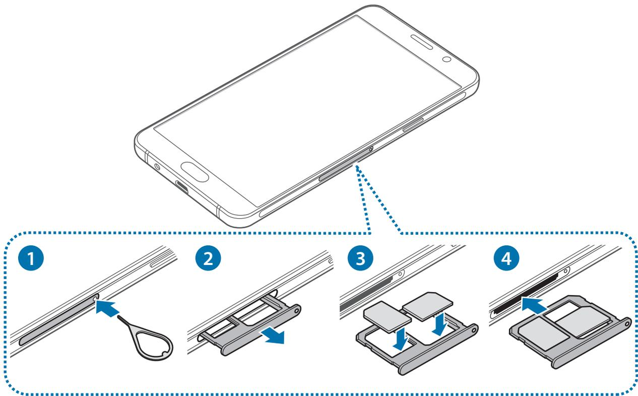
**1** Insérez l'outil de retrait à l'endroit prévu à cet effet sur le compartiment pour carte SIM et appuyez pour déverrouiller le compartiment.
