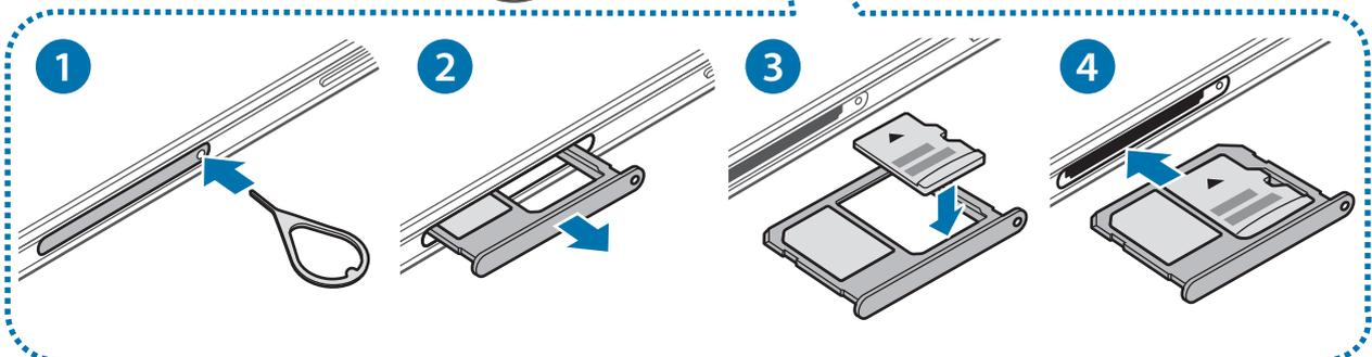
1 Insérez l'outil de retrait à l'endroit prévu à cet effet sur le compartiment pour carte mémoire et appuyez et relâchez pour déverrouiller le compartiment.
