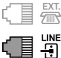
Lorsque vous connectez le téléphone à l'imprimante, vérifiez que l'imprimante est hors tension, branchez une extrémité du câble modulaire au connecteur de périphérique externe marqué « EXT. » sur l'imprimante, puis reliez l'autre extrémité au connecteur de ligne téléphonique du téléphone.
