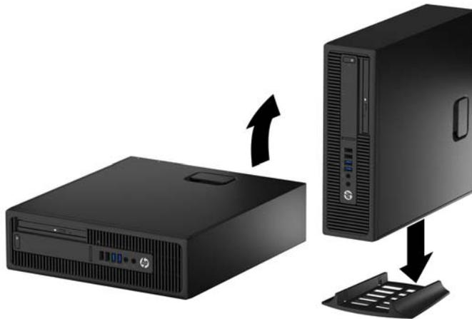
**📝 REMARQUE :** Pour stabiliser l'ordinateur en orientation tour, HP vous recommande d'utiliser un socle en option.
