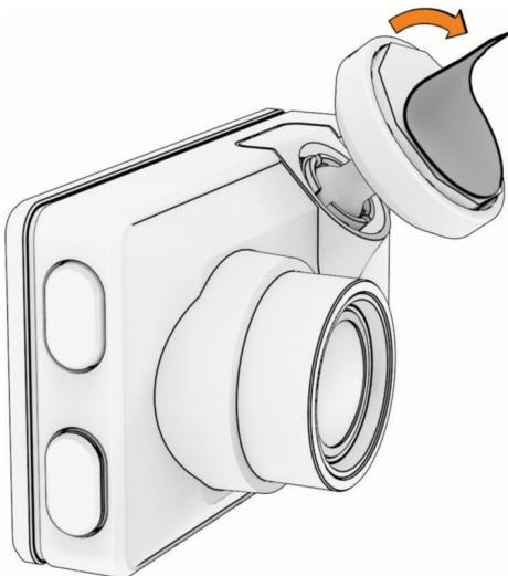
4 Positionnez le support au-dessus de l'emplacement de montage.
