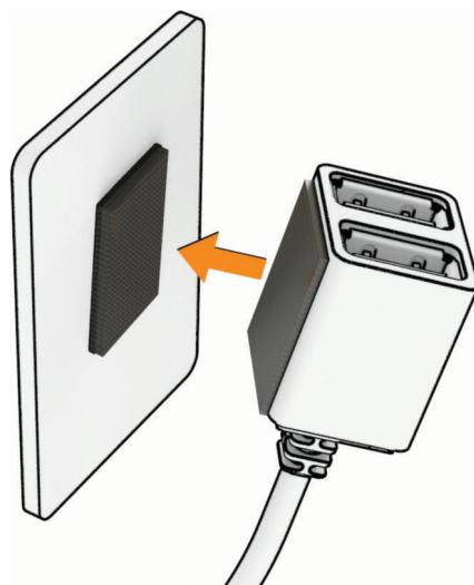
8 Connectez le câble d'alimentation USB de votre appareil Garmin Dash Cam sur un port USB du Constant Power Cable.
