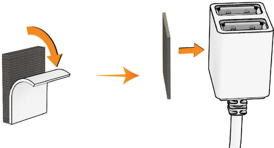
4 Nettoyez la surface de montage avec de l'eau ou de l'alcool et un chiffon non pelucheux.
