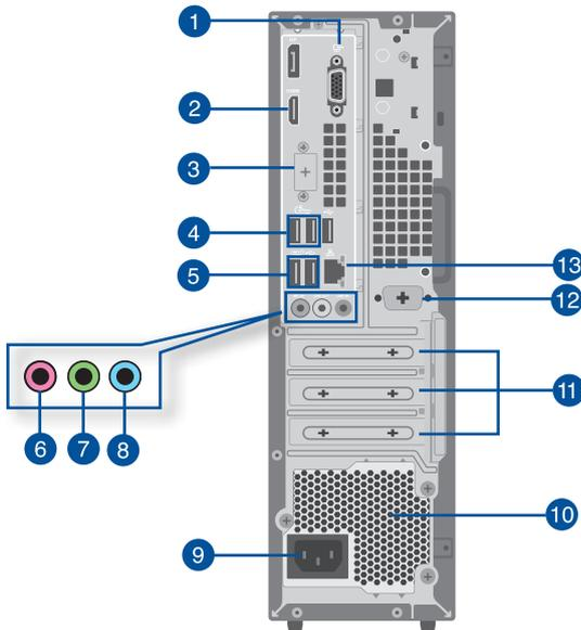
1. **Port VGA.** Ce port permet de connecter un moniteur VGA ou tout autre équipement doté d'un connecteur VGA.
